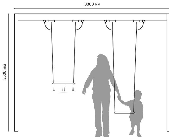
В раму из двутавровых балок мы вставляем термодревесину. Мы за естественное старение древесины, поэтому ничем её не обрабатываем. Благодаря термообработке она не гниёт, её не точат паразиты, но при этом она стареет естественно и красиво.
